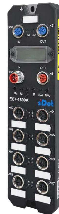
IP67 级总线 I/O 模块，支持多种总线协议。产品尺寸 225\*62\*35mm，壳体采用 PTB+GF30% 增强塑料材料，机械性能优异；全密封设计，能够适用于恶劣的工况环境。
