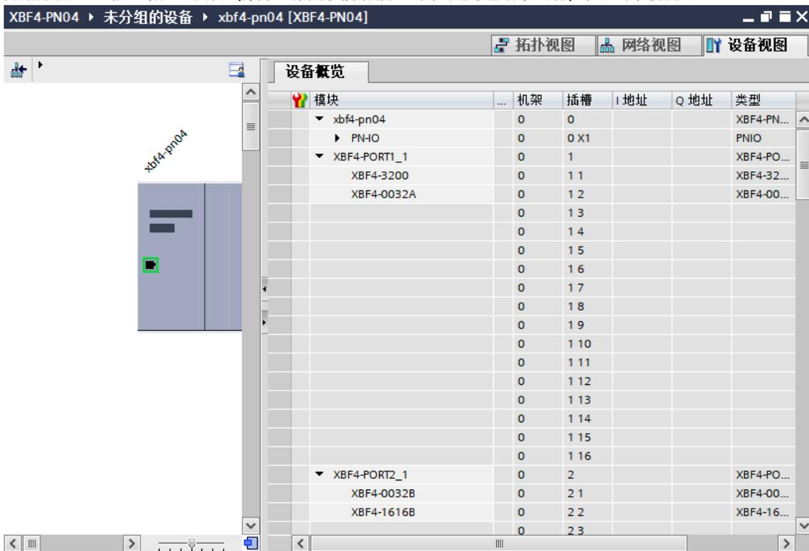
注意：IO 模块拨码站号需要与图上设置的插槽保持一致，拨码站号 0~F 与 4 个 XBF 接口的插槽 1~16 分别对应。
