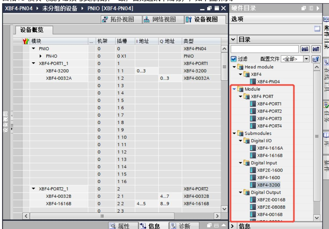
注意：IO 模块拨码站号需要与图上设置的插槽保持一致，拨码站号 0~F 与 4 个 XBF 接口的插槽 1~16 分别对应。
