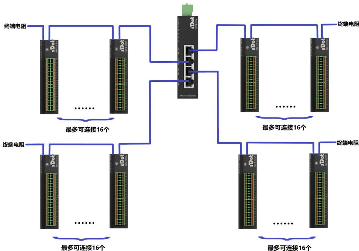
**产品组合方式二 (使用 2 个 XBF 接口, 每个接口最多接 16 个 I/O 模块, 一共最多 2\*16 个 I/O 模块)**
