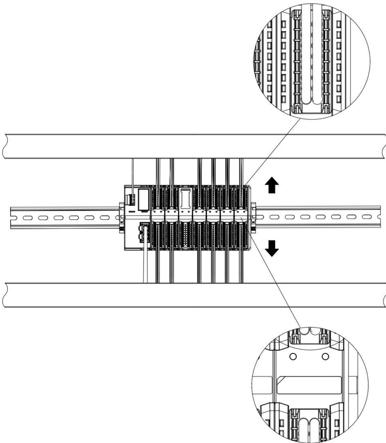
**确保模块竖直安装于固定导轨**
