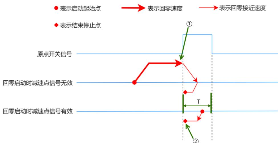
模块支持设置回零超时 0~100000ms，默认为 0 即关闭回零超时检测。四个输出通道共用此配置参数，不支持单独配置。
