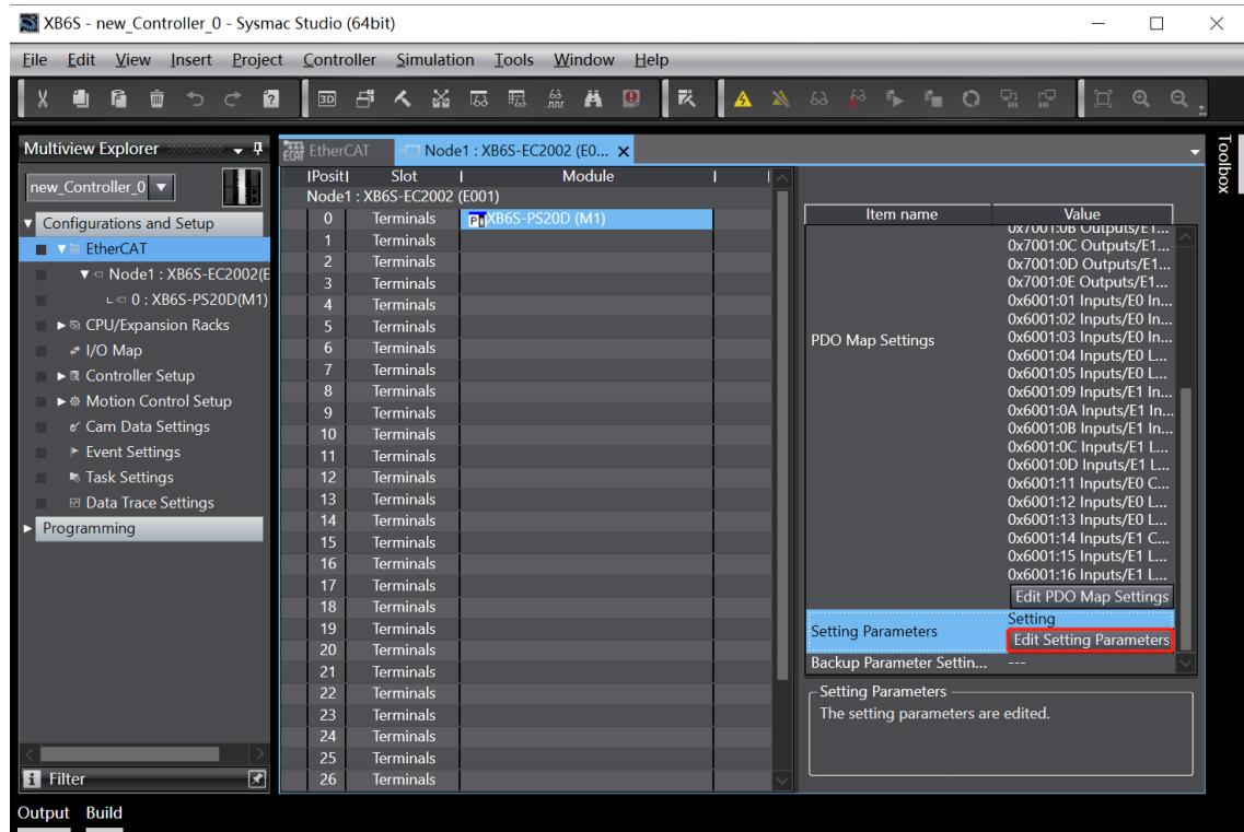
注：若 PLC 固件版本过低，需要用 EC\_CoESDOWrite、EC\_CoESDORRead 指令进行 SDO 地址的写入和读取。
