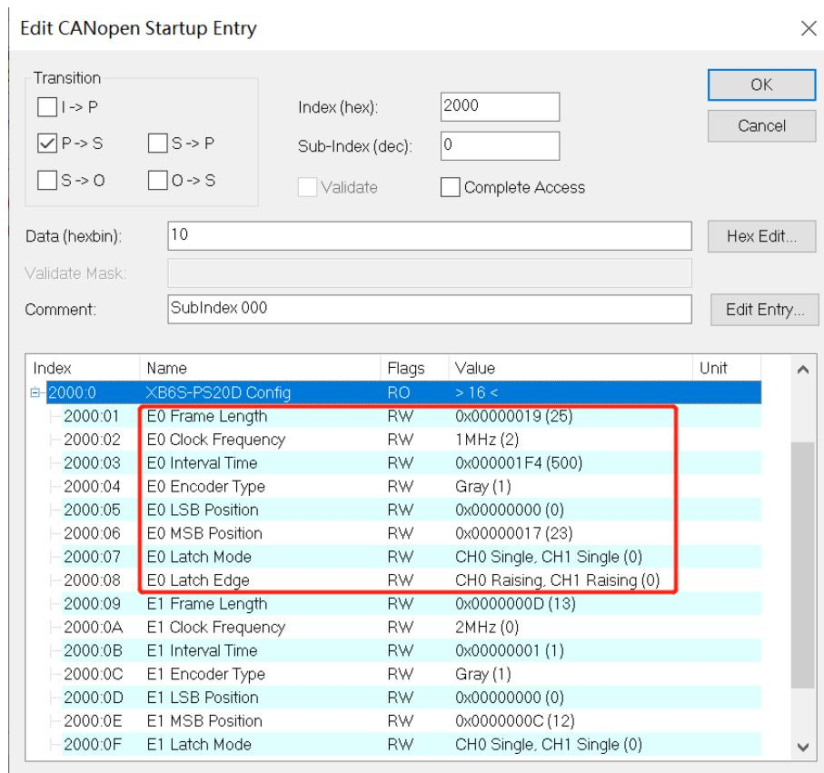
参数设置完成后，需进行 Reload 操作及模块重新上电，实现主站自动下发参数设定。
