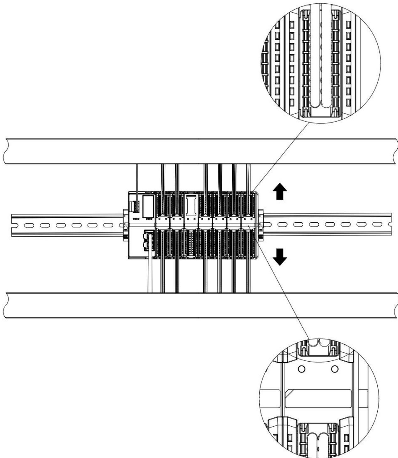
**确保模块竖直安装于固定导轨**
