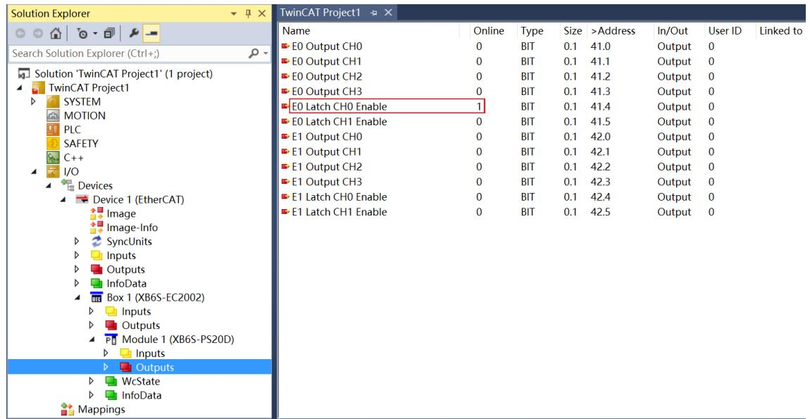
c. 编码器 0 开始转动，计数完成后，编码器 0 探针输入通道 0 输入有效信号，编码器 0 计数值为 4190，探针输入通道 0 锁存值为 4190，编码器探针输入通道 0 锁存完成标志位数值翻转一次为 1，如下图所示。
