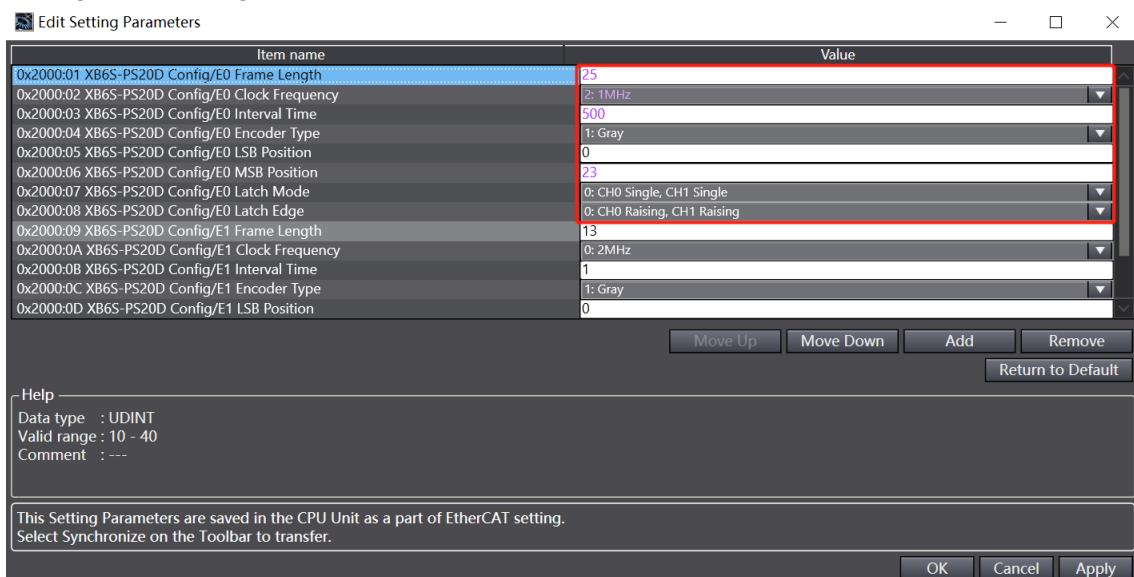
参数设置完成后，需进行 Reload 操作及模块重新上电，实现主站自动下发参数设定。
