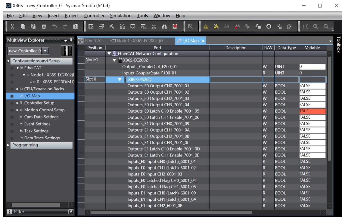
c. 编码器 0 开始转动，计数完成后，编码器 0 探针输入通道 0 输入有效信号，编码器 0 计数值为 4190，探针输入通道 0 锁存值为 4190，编码器探针输入通道 0 锁存完成标志位数值翻转一次为 1，如下图所示。
