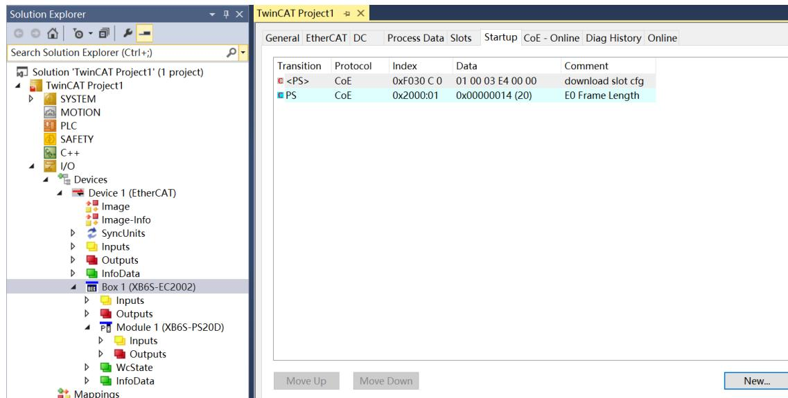
e. 左侧导航树 “Module 1 -> Inputs” 显示模块的上行数据，用于监视模块的输入，如下图所示。
