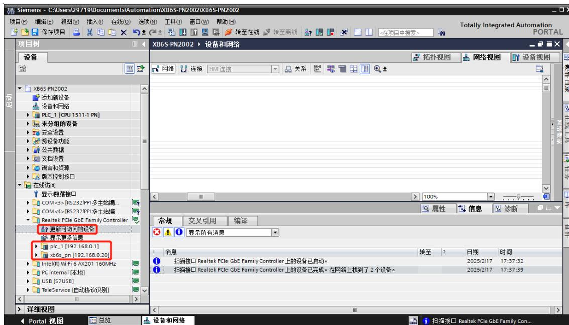
电脑的 IP 地址必须和 PLC 在同一网段，若不在同一网段，修改电脑 IP 地址后，重复上述步骤。
