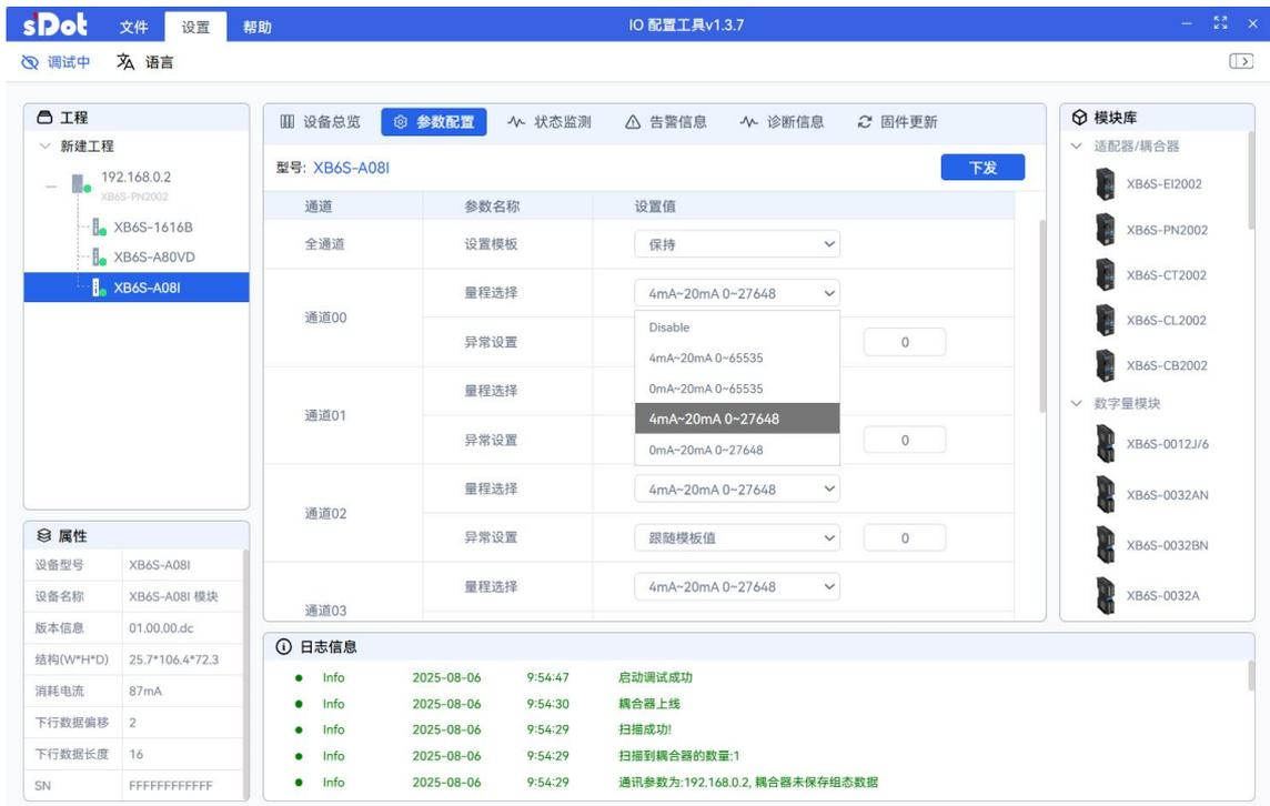
1. 模拟量输出信号清空/保持功能，默认所有通道为输出清空模式，模块通道可单独配置，对应关系参见 [6.1.6 模拟量输出信号清空/保持](#)，配置完成后，单击“下发”，如下图所示。
