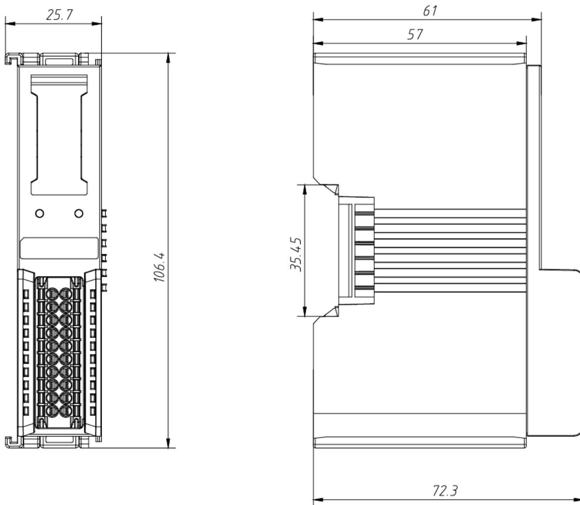
**32 通道数字量 I/O 模块外形规格 (单位 mm)**
