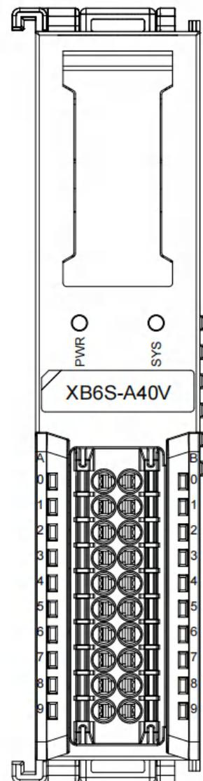
\*COM 内部导通, SHIELD 内部导通
