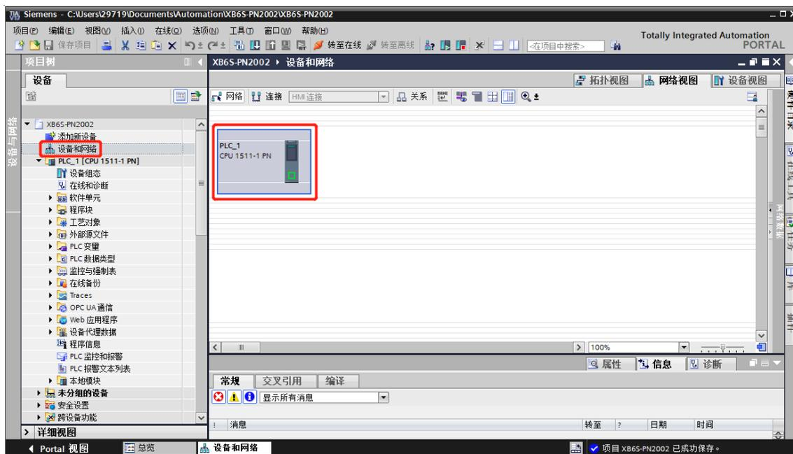
b. 菜单栏中，选择“在线 -> 硬件检测 -> 网络中的 PROFINET 设备”，如下图所示。
