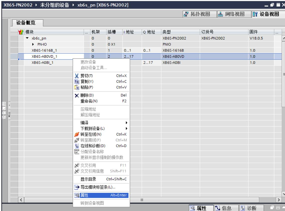
d. 在 XB6S-A80VD 属性页面，单击“模块参数”，如下图所示。参数可以根据实际使用需要进行配置，配置完成后，重新下载程序至 PLC 中，PLC 与模块需要重新上电。
