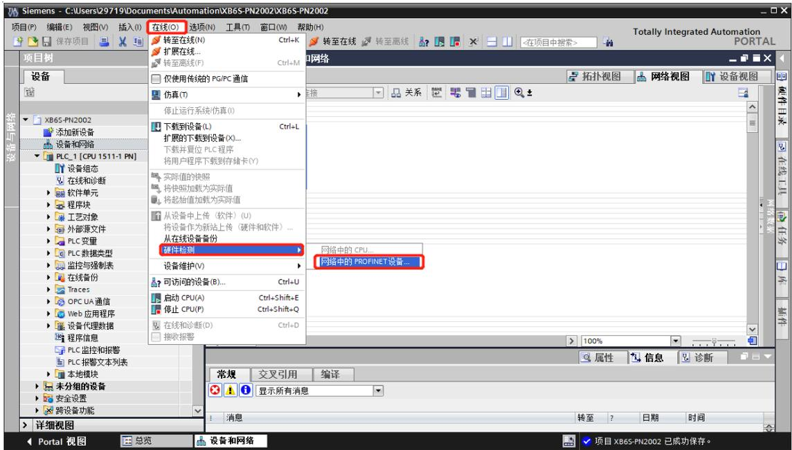
c. 弹出硬件检测窗口，选择正确的 PG/PC 接口，单击“开始搜索”，如下图所示。
