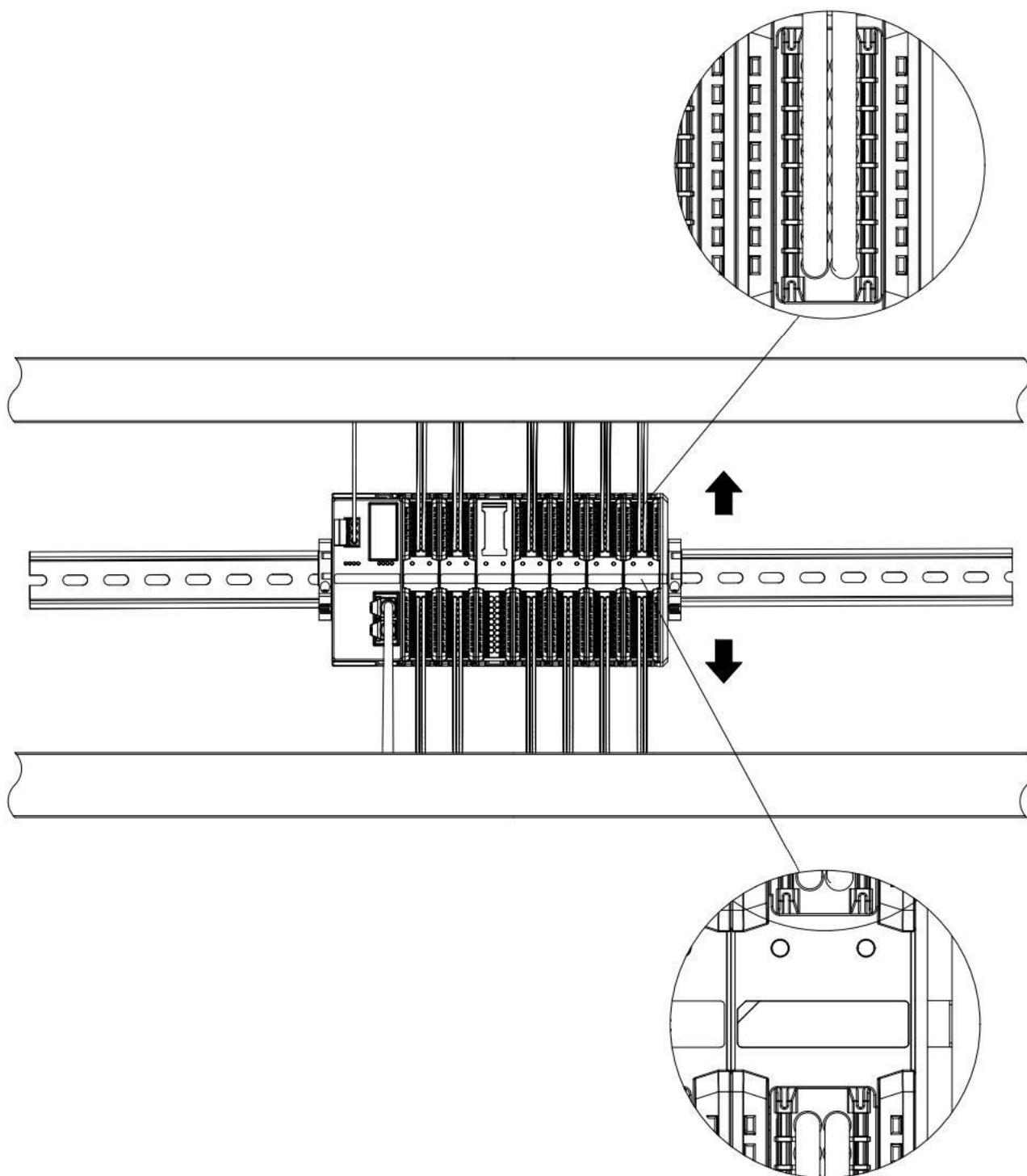
**确保模块竖直安装于固定导轨**
