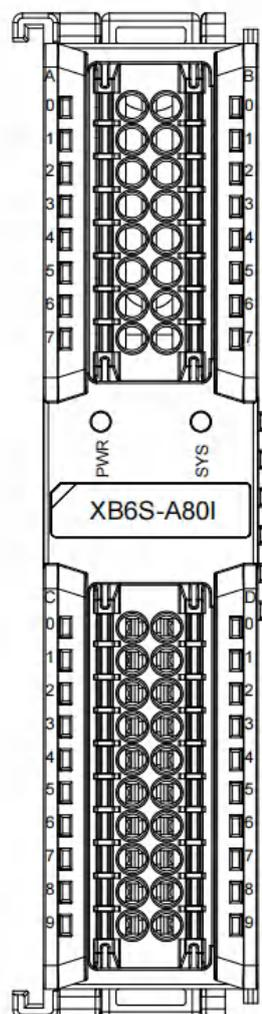
\*COM 内部导通，SHIELD 内部导通
