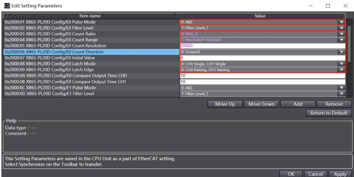
参数全部配置完成后，需重新下载程序至 PLC 中，PLC 与模块需要重新上电。
