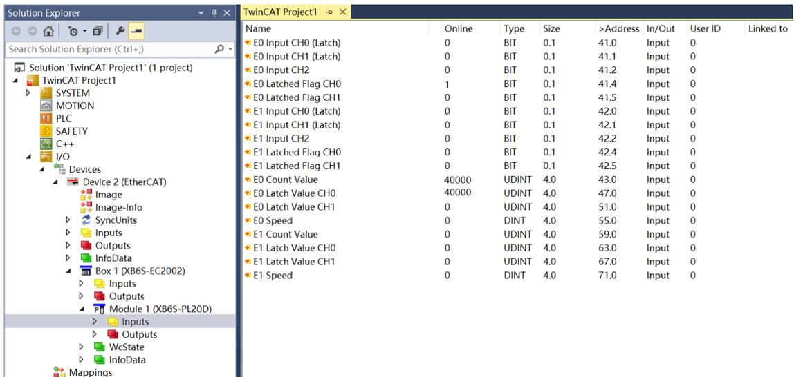
◆ 编码器 0 输入方向脉冲，脉冲数量 40000 个，编码器 0 比较输出通道 0 进行比较输出
