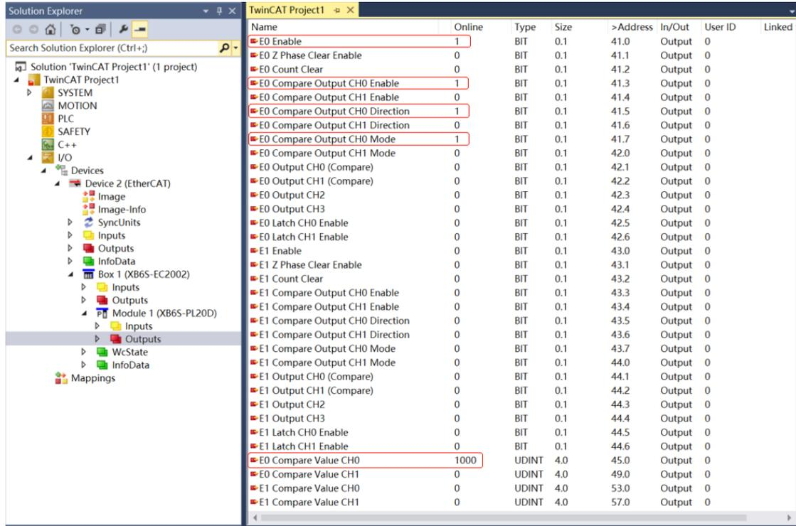
c. 编码器 0 开始输入脉冲 40000 个，计数值从 0 往上，达到 1000 时（满足比较设定值和方向），比较输出通道 0 状态发生翻转，由原本的低电平输出变为高电平输出，脉冲输出时间为 10s，通道指示灯将常亮 10s。计数完成后，编码器 0 计数值为 40000，如下图所示。
