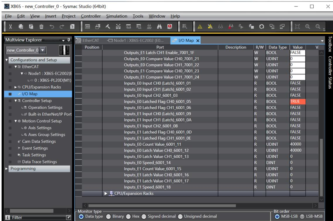
◆ **编码器 0 输入方向脉冲，脉冲数量 40000 个，编码器 0 比较输出通道 0 进行比较输出**
