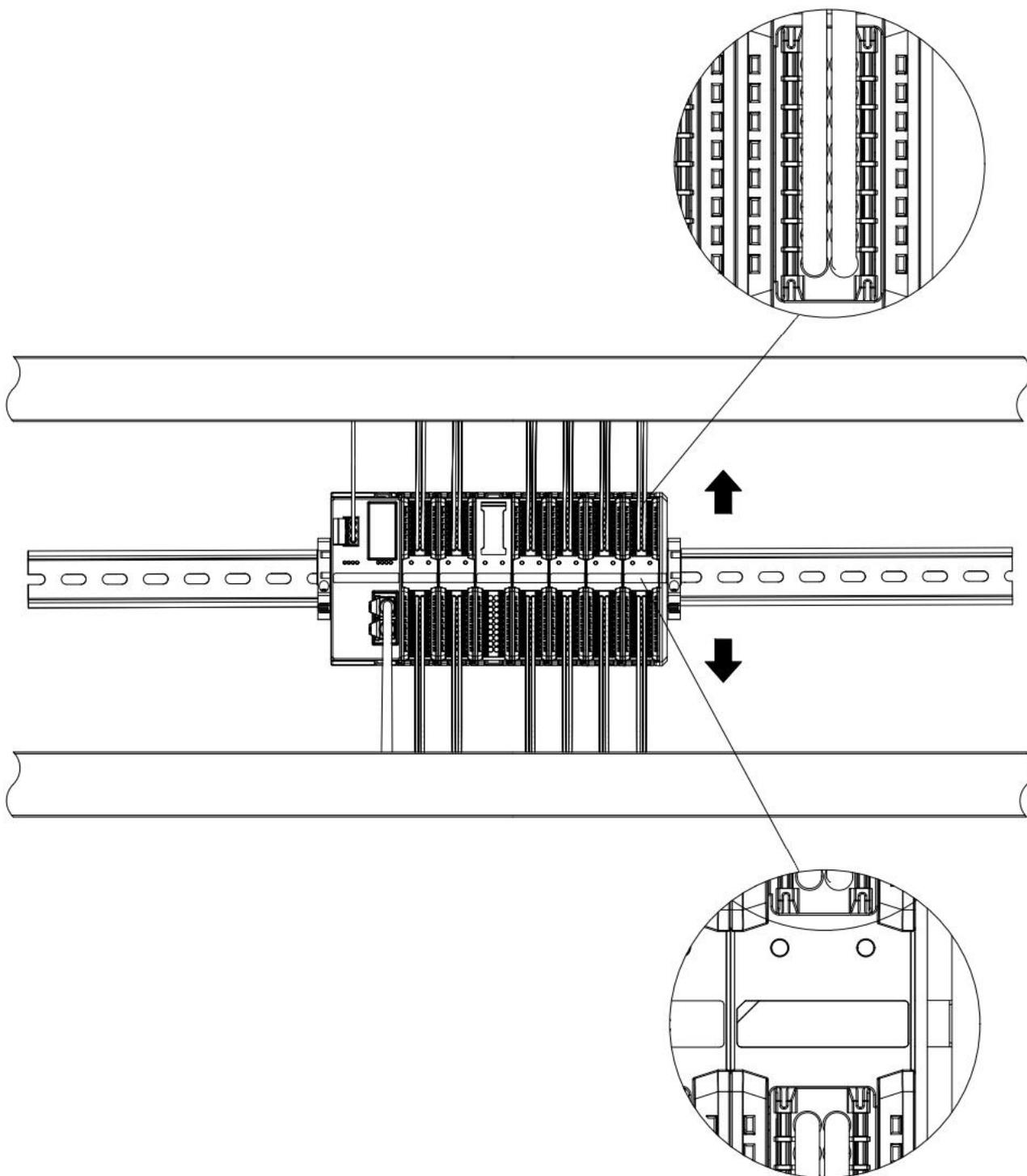
**确保模块竖直安装于固定导轨**
