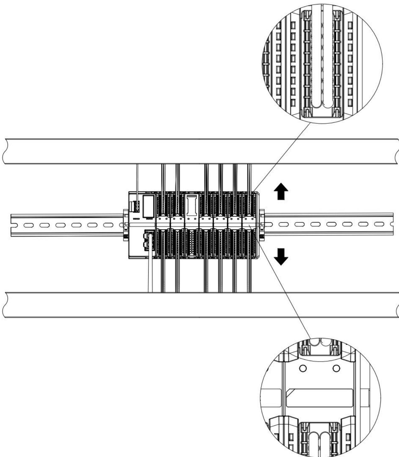
**确保模块竖直安装于固定导轨**
