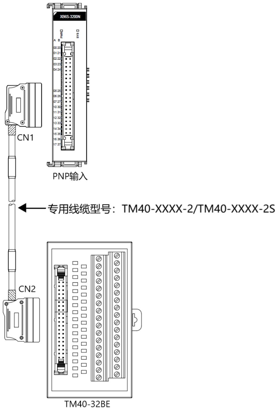
线缆两端有 CN1 和 CN2 标识，I/O 侧与 CN1 端相连，端子台侧与 CN2 端相连。
