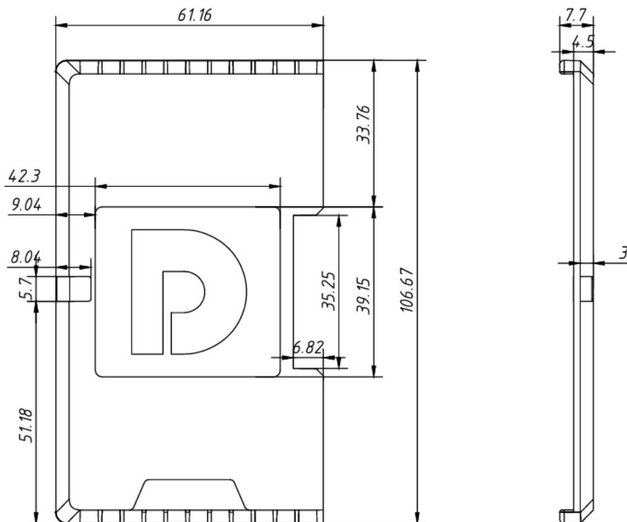
注：均采用 DIN 35 mm 标准导轨安装，DIN 导轨规格 35\*7.5\*1.0, 35\*15\*1.0 (单位 mm)。
