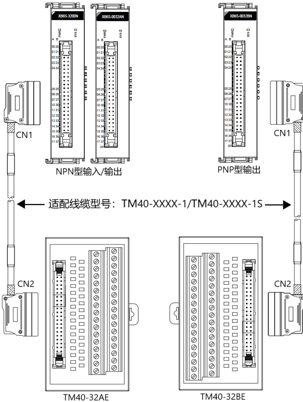
线缆两端有 CN1 和 CN2 标识, I/O 侧与 CN1 端相连, 端子台侧与 CN2 端相连。
