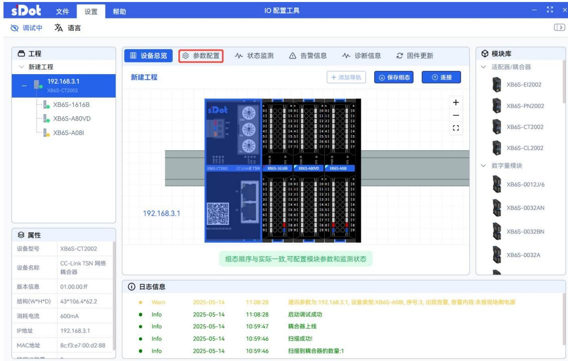
c. 在 XB6S-CT2002 参数设置页面，可以查看模块的安装信息、电气信息和通讯参数；对模块的网络参数和配置参数进行配置，如 IO 通信异常配置参数，可以根据实际使用需要进行配置，参数配置完成后，依次单击“下发”和“重启耦合器”，重启后配置的参数生效，如下图所示。
