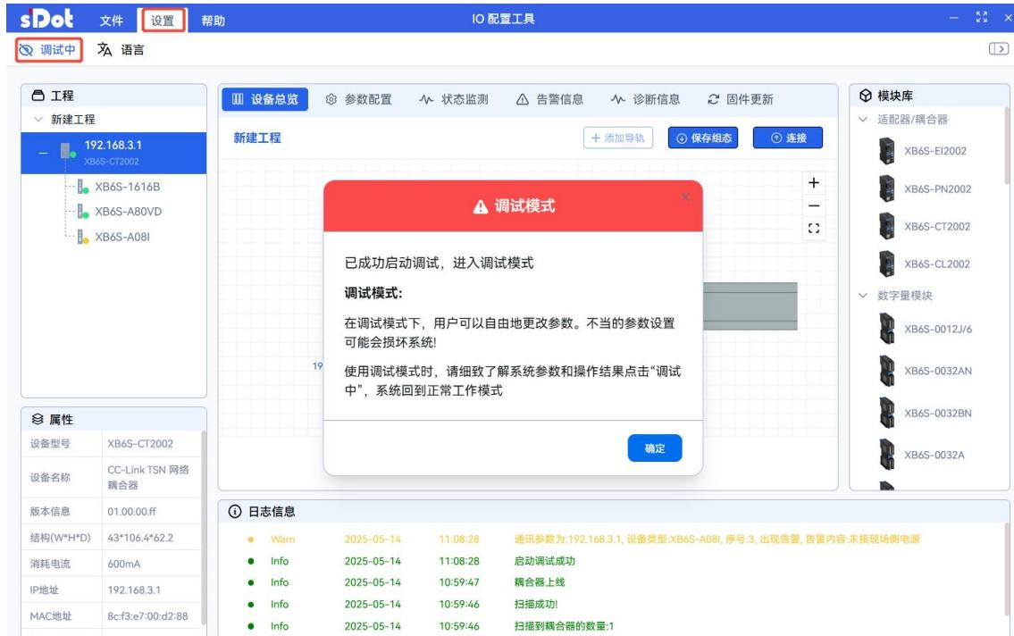
注：配置参数必须在调试模式下进行配置。
