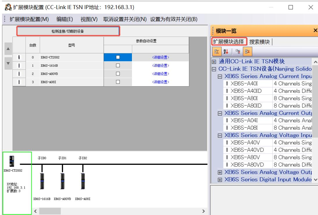
注：IO 模块添加完毕后，需检查 IO 模块 SYS 灯状态。SYS 灯常亮表示底部总线通讯成功；如 SYS 灯处于 1Hz 闪烁状态，则需要下发任意一个 IO 模块的参数来触发拓扑进行比对操作后，才能进行软元件控制。
