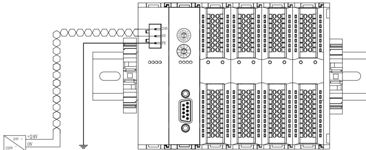
● 图 6-2 耦合器、I/O 模块、电源模块、I/O 模块、电源接线图
