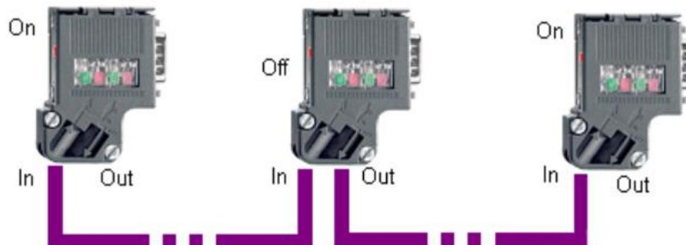
注：位于网络终端的总线连接器应该将 DP 电缆连接在 “In” 接口上，且终端电阻应该置于 “On” 位置。网络中间站点终端电阻应该置于 “Off” 位置。
