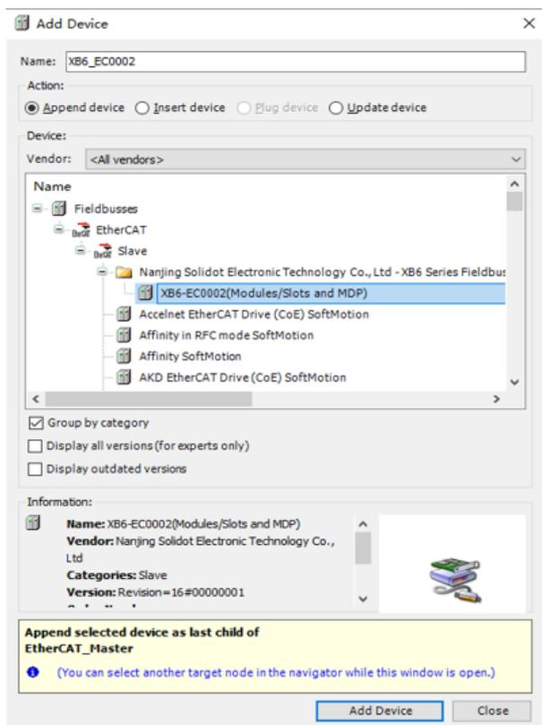
c. 选中耦合器，单击“Add Device”，添加 I/O 模块，如下图所示。
