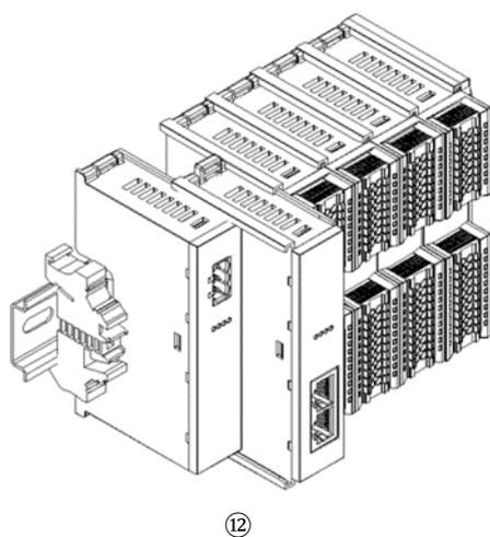
按安装模块相反的操作，拆卸模块，如左图⑫所示。
