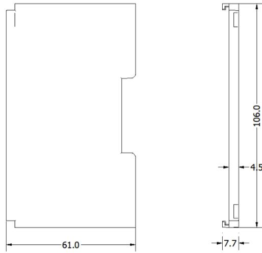
注：均采用 DIN 35 mm 标准导轨安装，DIN 导轨规格 35\*7.5\*1.0, 35\*15\*1.0 (单位 mm)。
