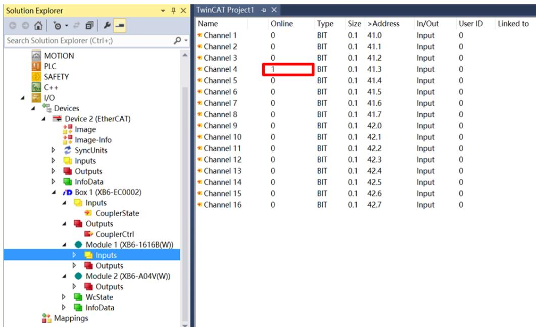
d. 以 XB6-1616B 模块的通道 1 为例，如果要让该模块数字量输出通道 Channel 1 输出，可以在 “Module 1 -> Outputs” 中点击 Channel 1，在对应的 “Online” 处单击 “Write”，在对应的对话框中 “Dec” 处输入数值 “1”，可在从该模块上看到对应的通道灯亮，如下图所示。
