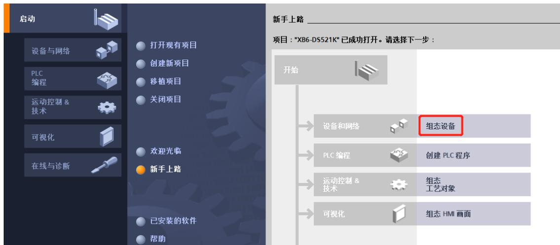
b. 单击“添加新设备”，选择当前所使用的 PLC 型号，单击“添加”，如下图所示。添加完成后可查看到 PLC 已经添加至设备导航树中。
