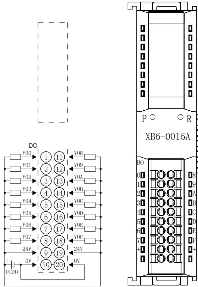
\*24V内部导通;OV内部导通
