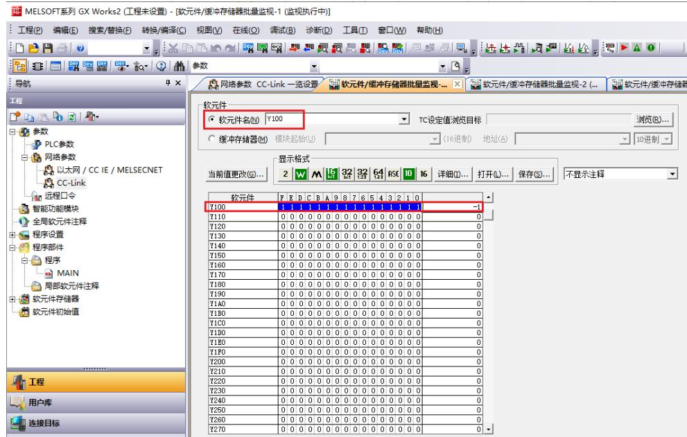
e. XB6-A08V 模块有 8 个模拟量输出通道，每个通道占用 2Bytes，起始地址为 D200，对应 D200~D207，可修改 D200~D207 的数值为电压码值，监视界面如下图所示。
