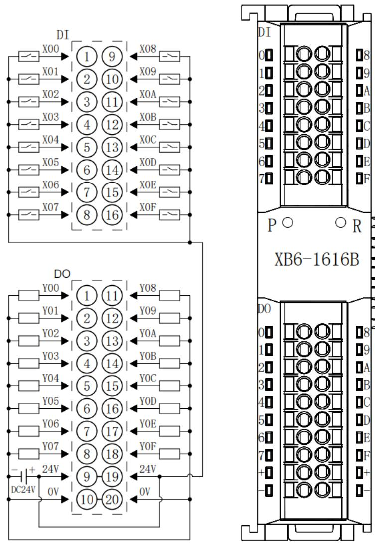
\*24V内部导通;OV内部导通
