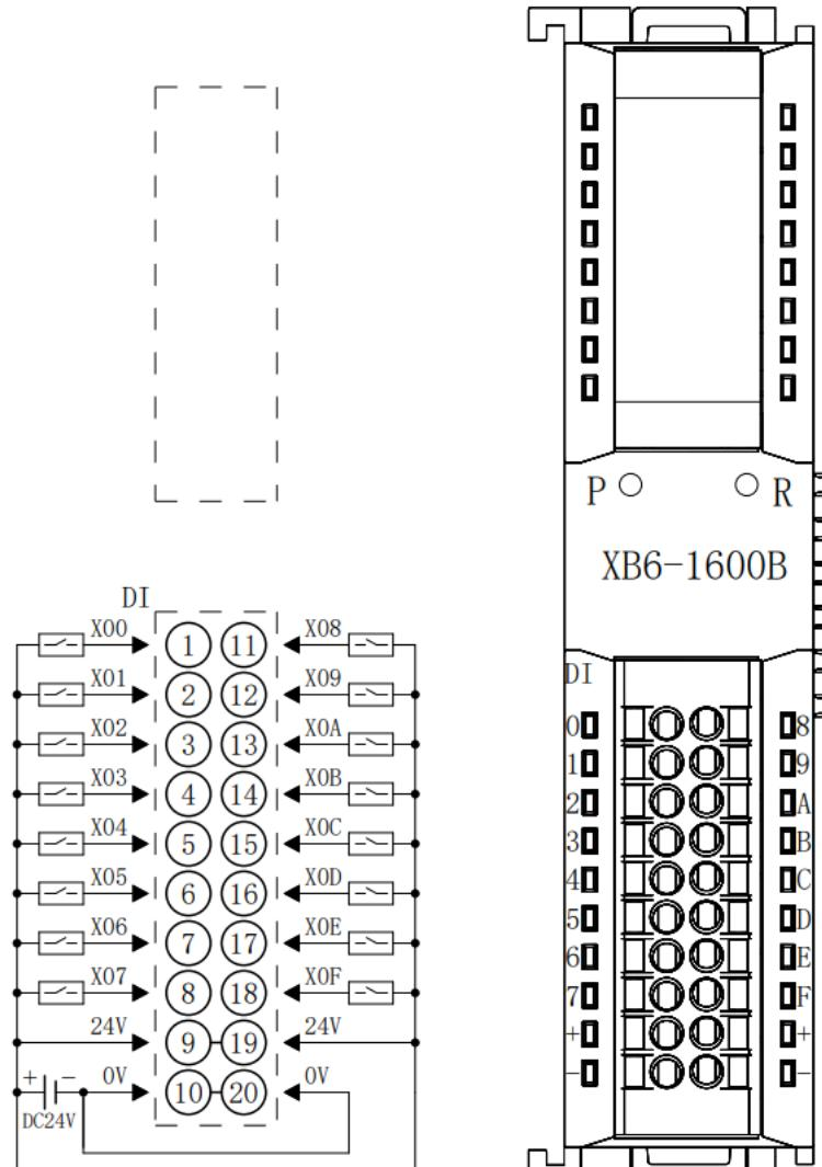
\*24V内部导通;OV内部导通
