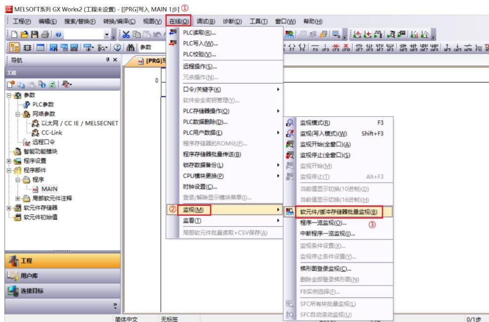
b. 重复上述操作，建立四个监视界面。在四个监视界面的“软元件名”中分别输入如网络参数设置界面中所设置的“远程输入(RX)刷新软元件”，“远程输出(RY)刷新软元件”，“远程寄存器(RWr)”，“远程寄存器(RWw)”的参数，即“X100”、“Y100”、“D100”、“D200”，监视设置完成。请参考 [7.2.3](#)，对数据位进行操作。
