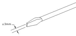
总线接口接线端子采用免螺丝设计，接线端的插拔式连接器两端采用固定螺丝设计，连接器的固定和线缆的安装及拆卸均可使用一字型螺丝刀（规格： $\leq 2\text{mm}$ ）操作。
