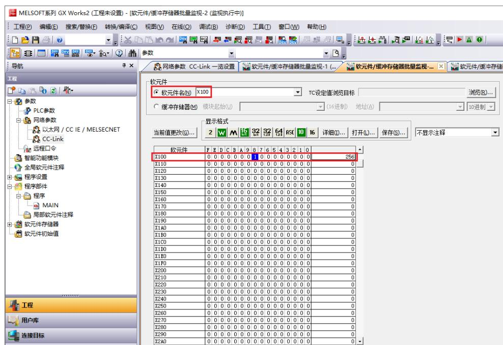
d. XB6-1616B 模块有 16 个输出通道，每个通道占用 1Bit，对应 Y100 (0~F)，双击数值可以修改通道值，0~F 任意通道数值为 1 时，对应通道的指示灯常亮，通道数值为 0 时，对应通道的指示灯熄灭，监视界面如下图所示。
