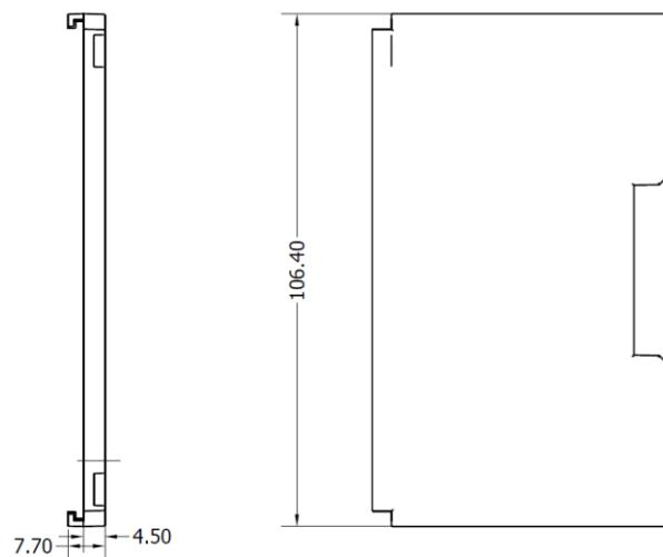
注：均采用 DIN 35 mm 标准导轨安装，DIN 导轨规格 35\*7.5\*1.0, 35\*15\*1.0 (单位 mm)。
