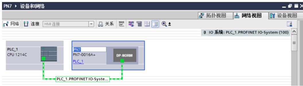
g. 单击“设备视图”进入设备概览，可以看到拓扑组态信息，包括系统自动分配的 I/O 地址，I/O 地址可以自行更改，如下图所示。
