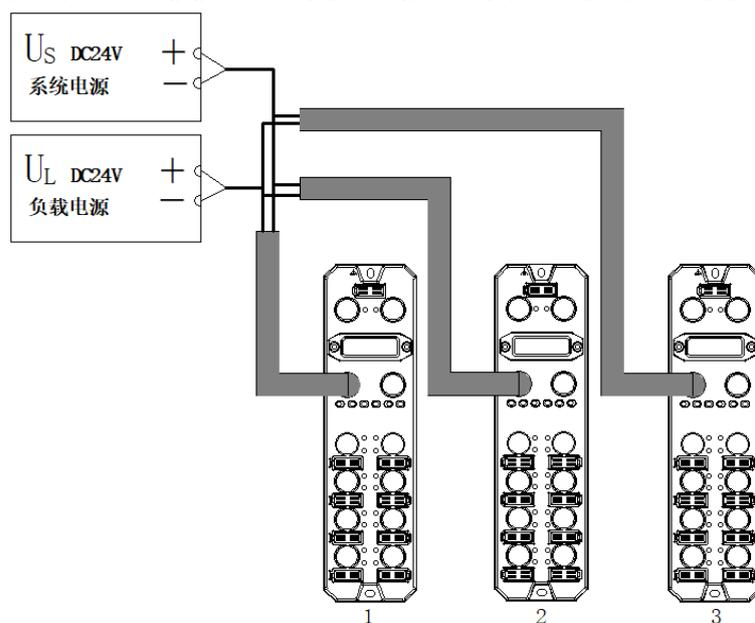
电源电缆中的压降根据模块的负载电源的消耗电流总和以及线缆材质不同而有差异，下表为使用我司标配线缆时的压降。
