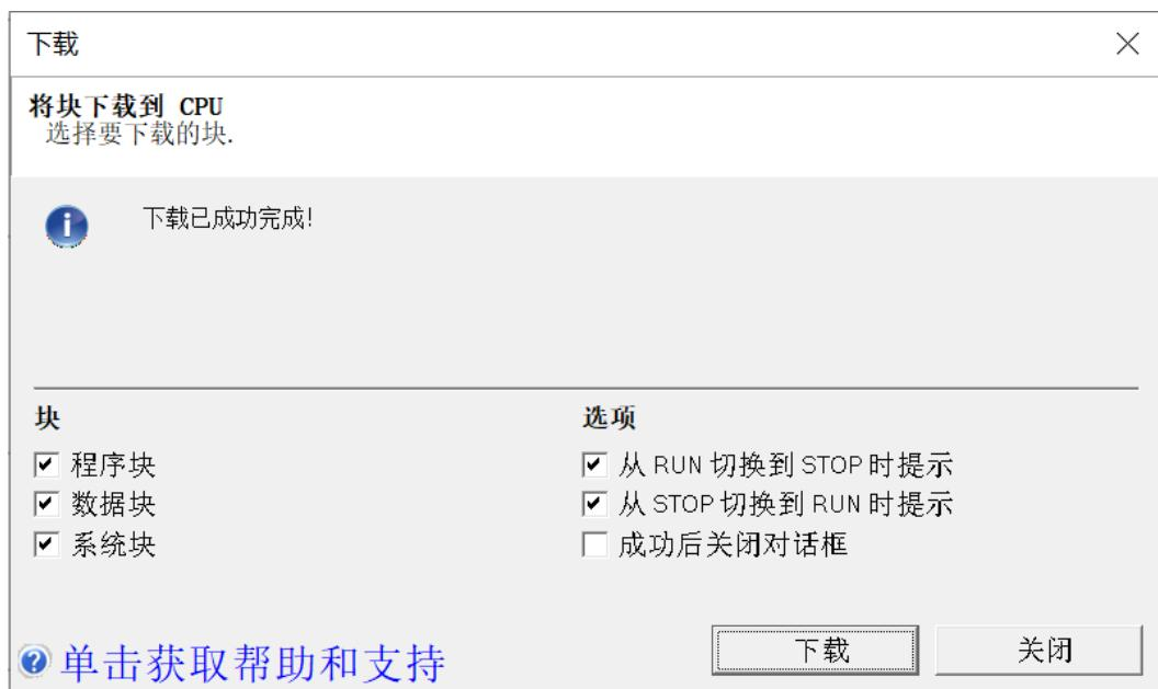
注：下载完成后，将模块重新上电处理。
