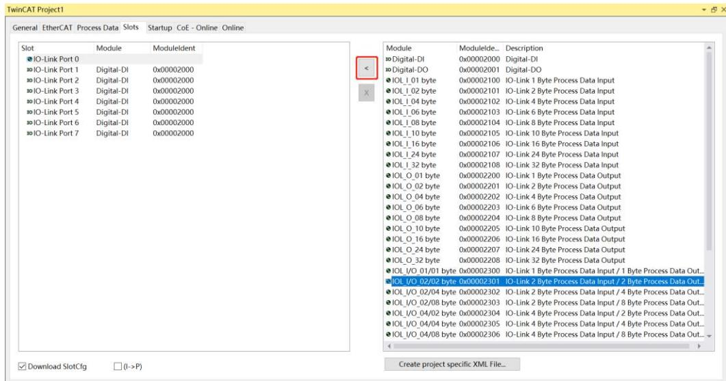
d. 添加完成后，左侧 Port0~7 如下图所示。其他端口配置 DI/DO/IO-Link 方法与此处方法一致。
