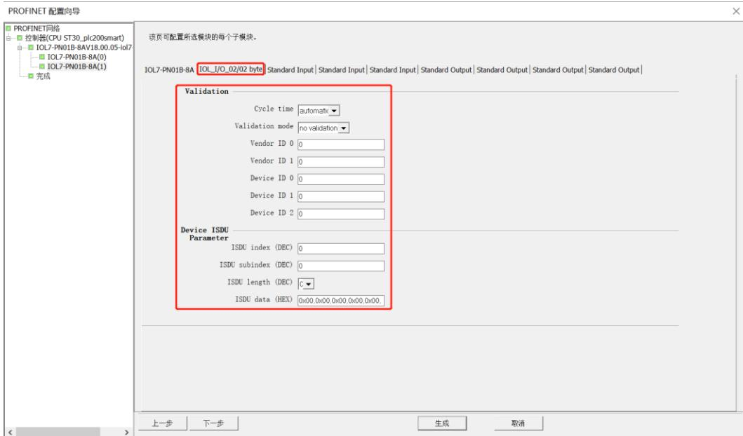
d. 单击“下一步”，单击“生成”，完成组态网络配置和参数配置，如下图所示。
