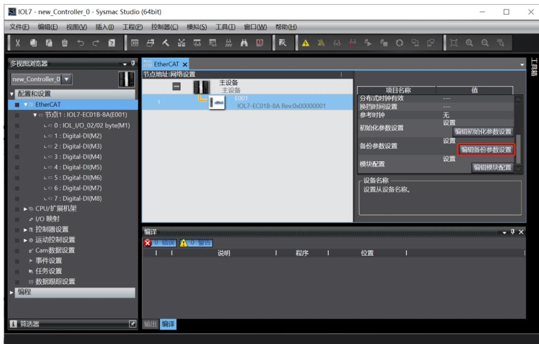
d. 在备份参数设置页面，可以查看主站端口 0~7 的 IO-Link 信息，如下图所示。
