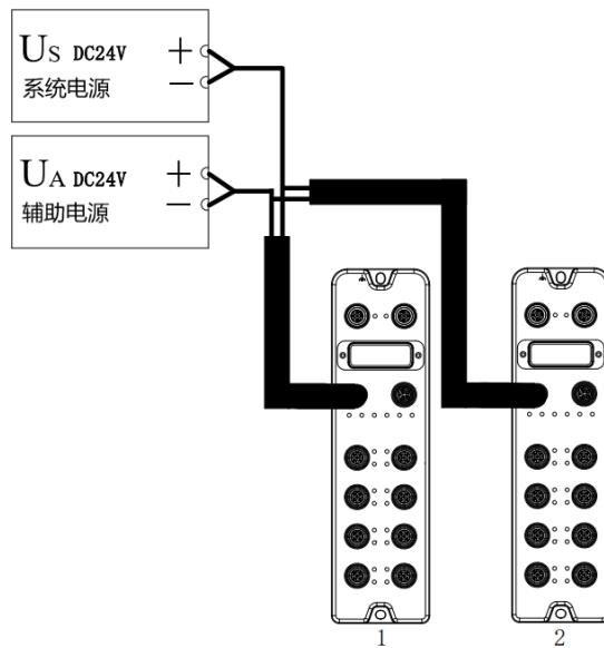
电源电缆中的压降根据模块电源的消耗电流总和以及线缆材质不同而有差异，下表为使用我司标配线缆时的压降。
