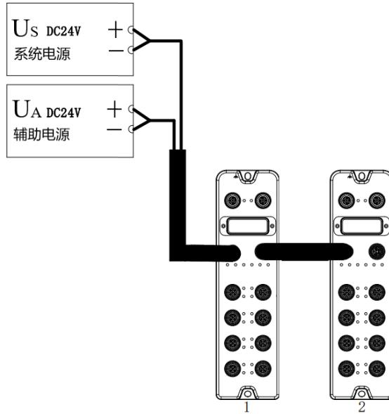
串联供电时，模块内部会有串联模块的消耗电流流过，因此会在模块内部回路中产生电压降。电源电缆中的压降根据模块电源的消耗电流总和以及线缆材质不同而有差异，下表为使用我司标配线缆时的压降。
