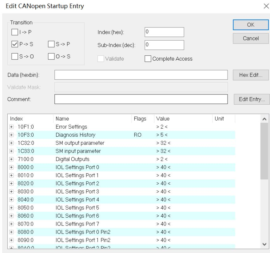
c. 输出清空保持功能配置方法：以 Port 0 Pin 4 为例，单击“New”进入“Edit CANopen Startup Entry”界面，双击“8200:01”进行清空/保持功能配置，如下图所示。配置完成后，单击“OK”。
