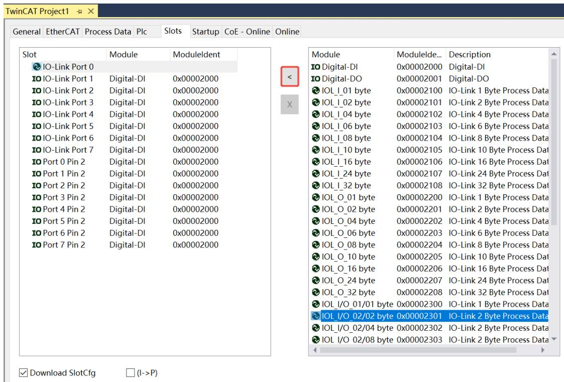
d. 添加完成后, 左侧 Port0~7 如下图所示。其他端口配置 DI/DO/IO-Link 方法与此处方法一致。
