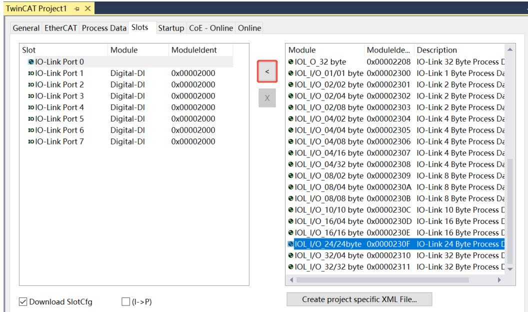
d. 添加完成后，左侧 Port0~7 如下图所示。其他端口配置 DI/DO/IO-Link 方法与此处方法一致。
