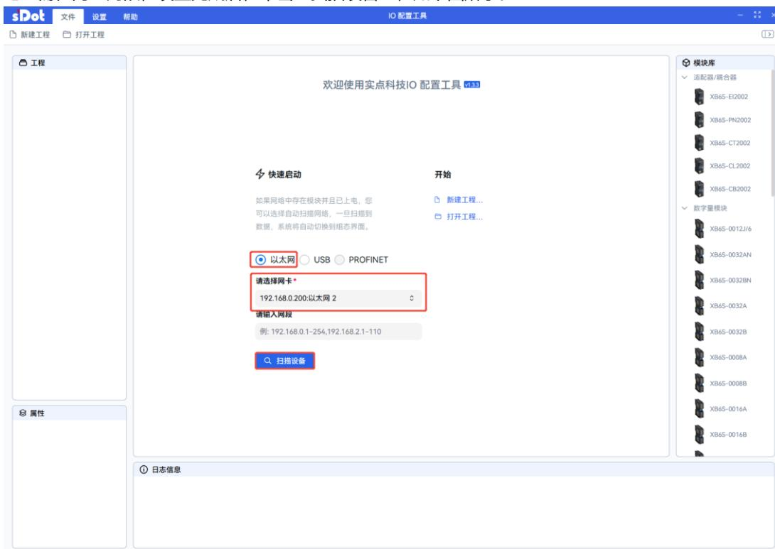
注：若使用 XB6S-CL2002 耦合器组态时，选择“USB”模式，选择对应的串口扫描设备。
