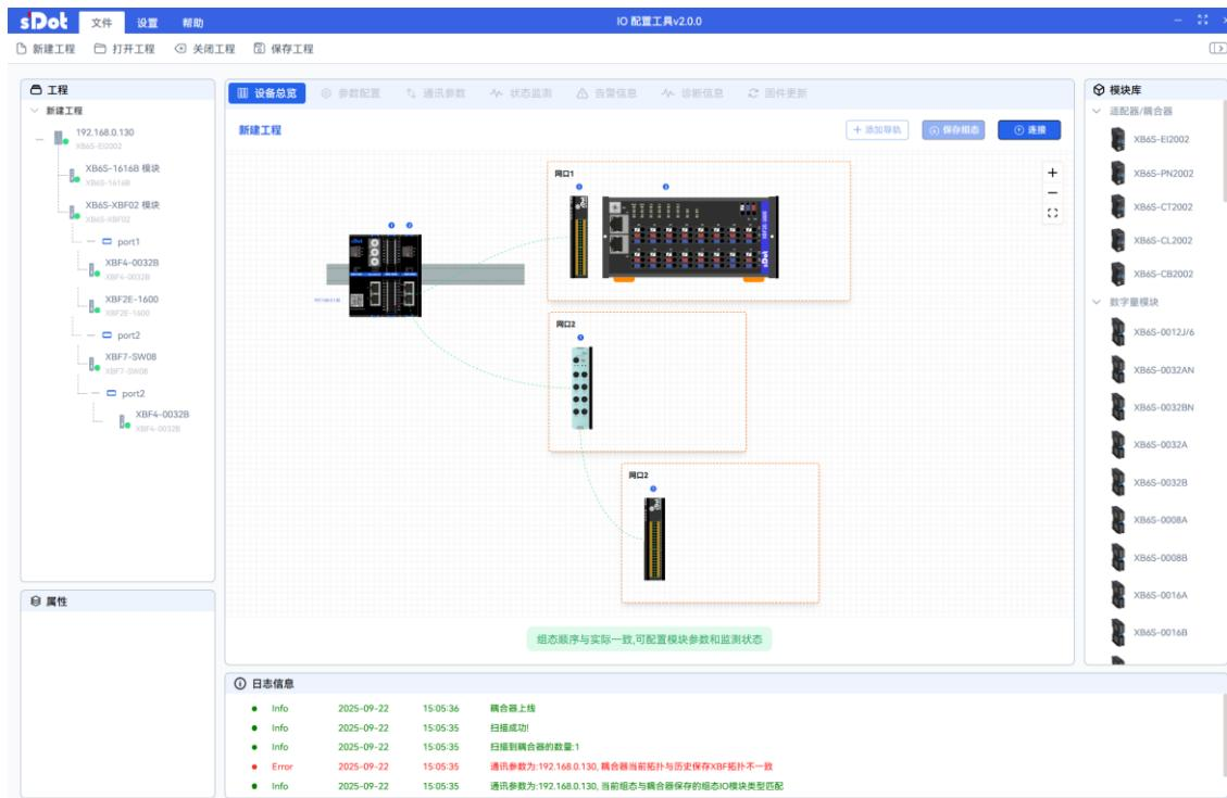
c. 当兼容节点模块接入交换机任意网口并第一次扫描时都需先手动添加，选中拓扑中的 XBF7-SW08 模块，单击“网口 1 扩展”，弹出交换机网口 1 区域，如下图所示。
