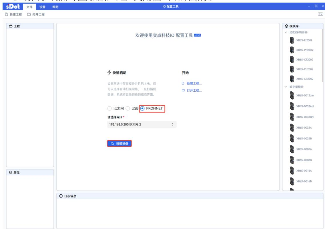
b. 扫描成功后，弹出设备列表窗口，可以设置 PROFINET 设备的网络参数和设备名称，如下图所示。
