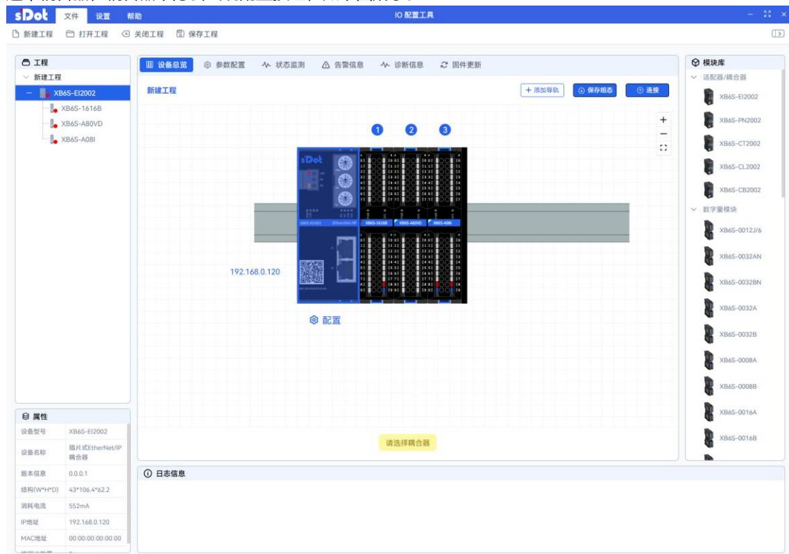
f. 选中 IO 模块，IO 模块下方会出现配置和删除两个按钮，如下图所示。
