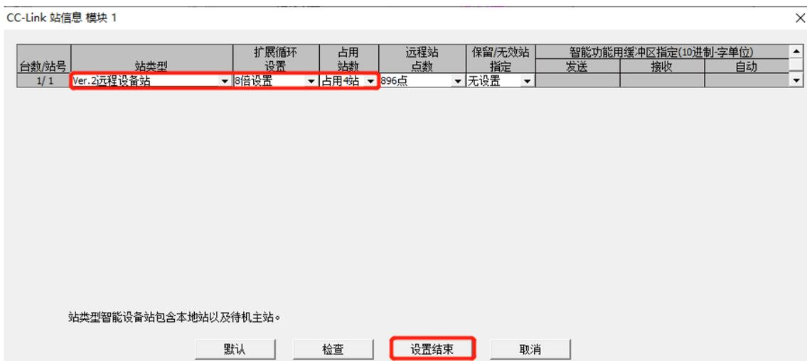
站信息设置结束后需单击“设置结束”，再进行 PLC 写入操作，否则参数将无法适用。
