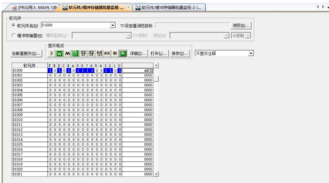
c. 此时，GX Works2 软件上行数据最后一个状态位字节为 16#01 表示网关之间有数据交互，如下图所示。
