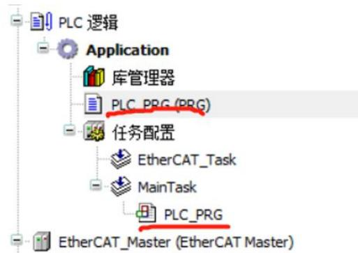
删除后，右击 Application——添加对象——POU...（实现语言这里选择连续功能图（CFC））。然后双击 POU（PRG），点击最右侧工具箱中的运算块，会出现一个空的运算块点击空的运算块中的问号出现如下图片。然后选择功能块——SM3\_Basic——SM3\_Basic——POUs——Movement——MC\_MoveAbsolute。
