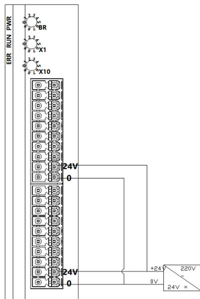
信号端子接线参照接线说明，将信号线压入接线端子
