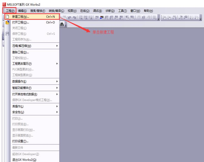
弹出新建工程对话框，工程类型选择简单工程，PLC 系列选择 QCPU(Q 模式)，PLC 类型选择 Q00UJ，程序语言默认梯形图，单击“确定”完成工程创建。
