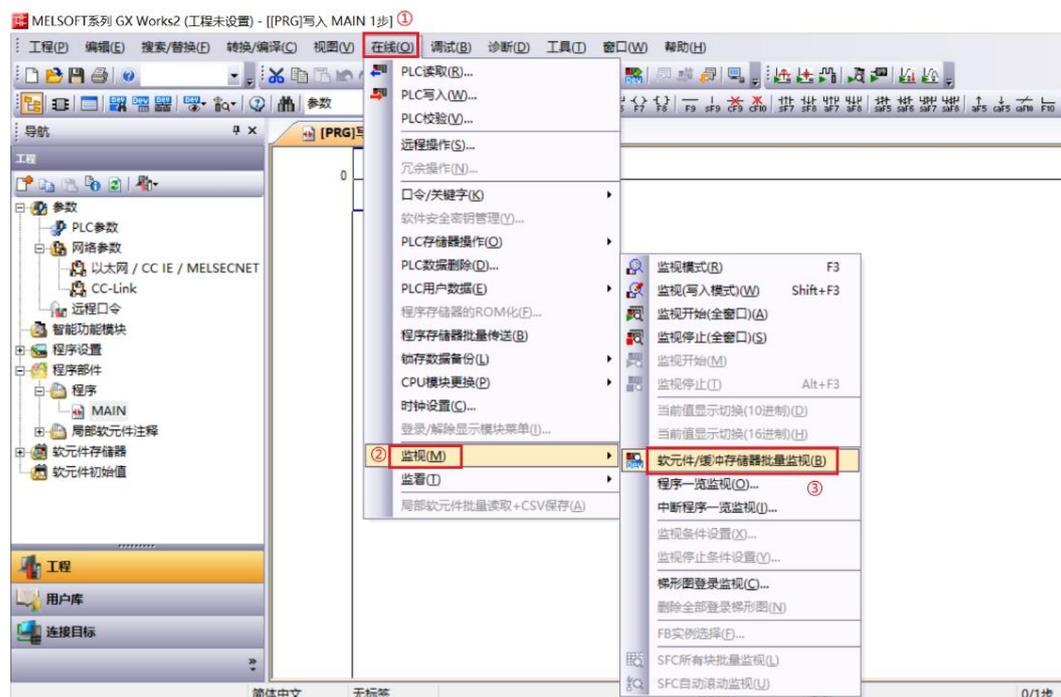
b. 重复上述操作，建立两个监视界面。在两个监视界面的“软元件名”中分别输入如网络参数设置界面中所设置的“远程输入(RX)刷新软元件”，“远程输出(RY)刷新软元件”的参数，即“X100”、“Y100”，监视设置完成。请参考 7.1.2，对数据位进行操作。
