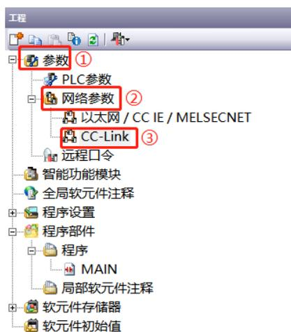
b. 在“网络参数 CC-Link 一览设置”界面中，配置相关参数，如下图所示。
