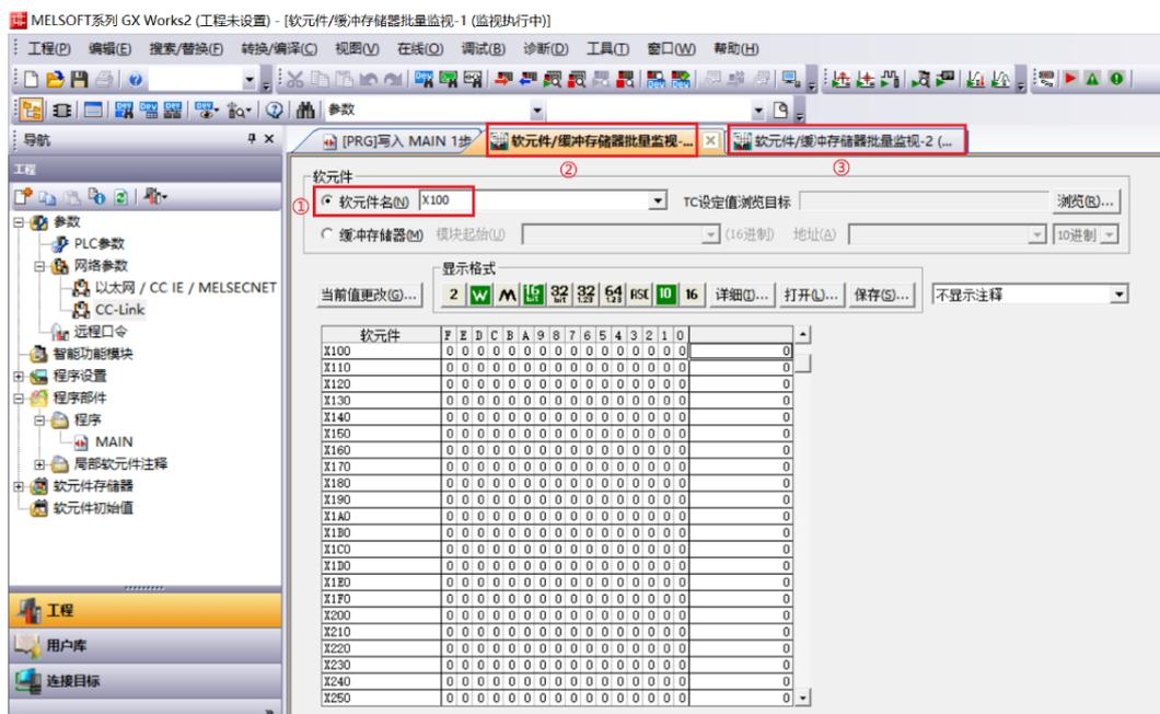
c. 在 X100 监视界面，软元件地址 0~7 对应输入通道 0~7，可以监视输入通道 0~7 的输入值，如下图所示。
