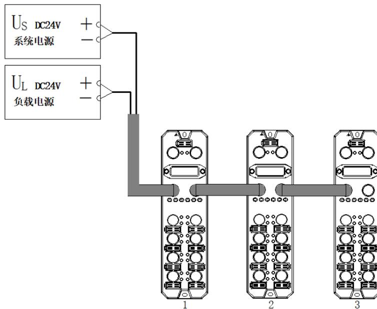
串联供电时, 模块内部会有串联模块的消耗电流流过, 因此会在模块内部回路中产生电压降。电源电缆中的压降根据模块的负载电源的消耗电流总和以及线缆材质不同而有差异, 下表为使用我司标配线缆时的压降。
