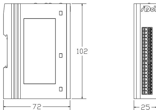
**备注：**采用 DIN 标准 35 mm 导轨、卡扣式安装，DIN 标准导轨采用 35\*7.5\*1.0，35\*15\*1.0。
