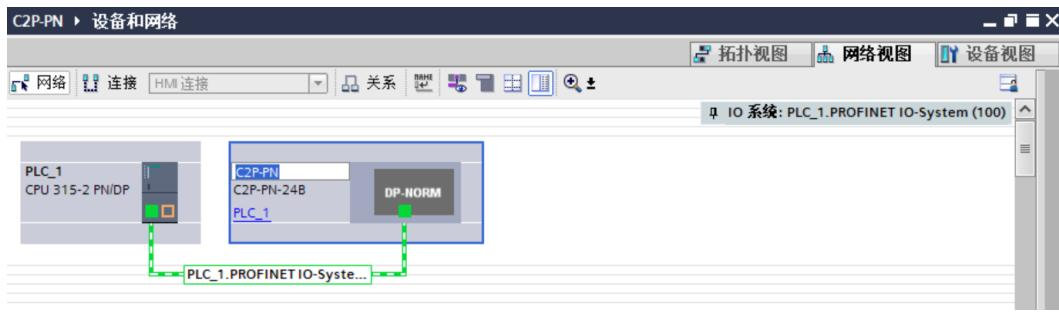
g. 单击“设备视图”进入设备概览，可以看到拓扑组态信息，包括系统自动分配的 I/O 地址，I/O 地址可以自行更改，如下图所示。
