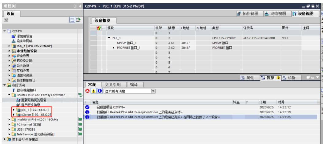
电脑的 IP 地址必须和 PLC 在同一网段，若不在同一网段，修改电脑 IP 地址后，重复上述步骤。
